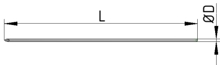
Gwóźdź prowadzący \varnothing D \times L Guide Nail \varnothing D \times L
